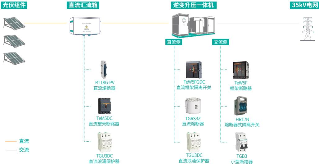
**方案齐全:**交直流元器件产品覆盖齐全,适用于直流汇流箱、箱逆变一体机侧,同时可提供直流汇流箱整柜设备。
